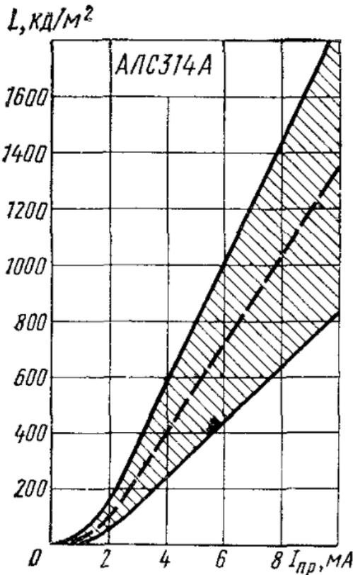
Зависимость яркости индикатора от постоянного прямого тока при  $T = +25 \pm 10^\circ\text{C}$ . Заштрихована область разброса значений параметра для 95 % индикаторов. Штриховой линией обозначена типовая зависимость
