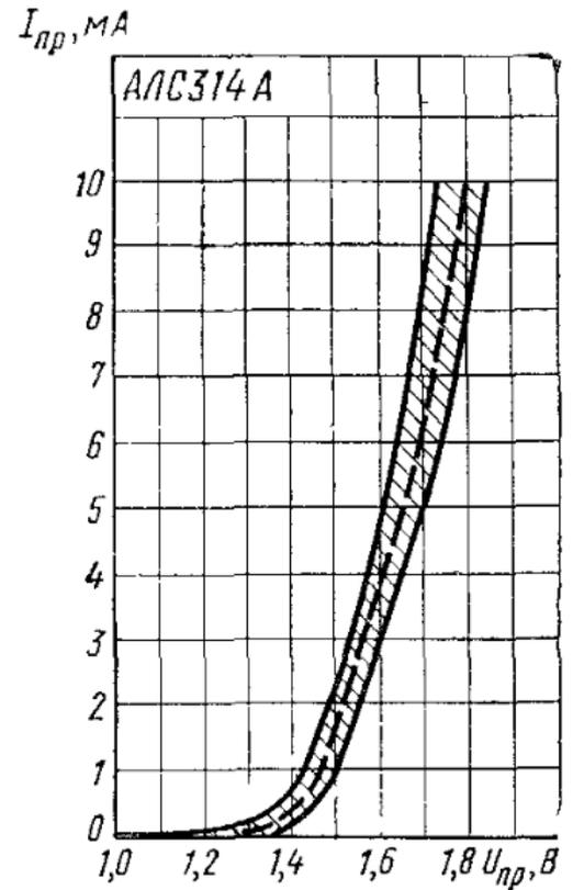
Зависимость прямого тока от прямого напряжения при  $T = +25 \pm 10^\circ\text{C}$ . Заштрихована область разброса значений параметра для 95 % индикаторов. Штриховой линией обозначена типовая зависимость
